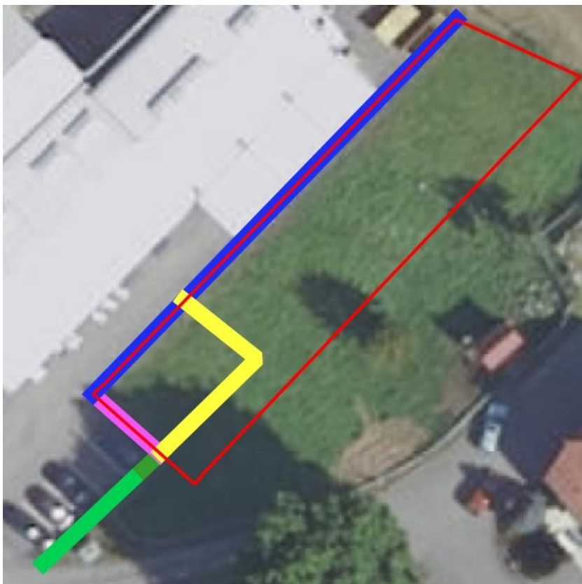
Karte 3: CEF-Maßnahme 1 und darüber hinaus durch das Vorhaben neu entstehende Natursteinmauern - hellgrün: CEF1, Natursteinmauer, Freistellen von Efeu, dunkelgrün: Natursteinmauer, für Eidechsen geeignet, bleibend, gelb: Natursteinmauer, durch das Vorhaben neu entstehend, lila: Natursteinmauer-Rückbau, blau: Betonmauer-Rückbau; rote Umrandung: Vorhabensfläche
