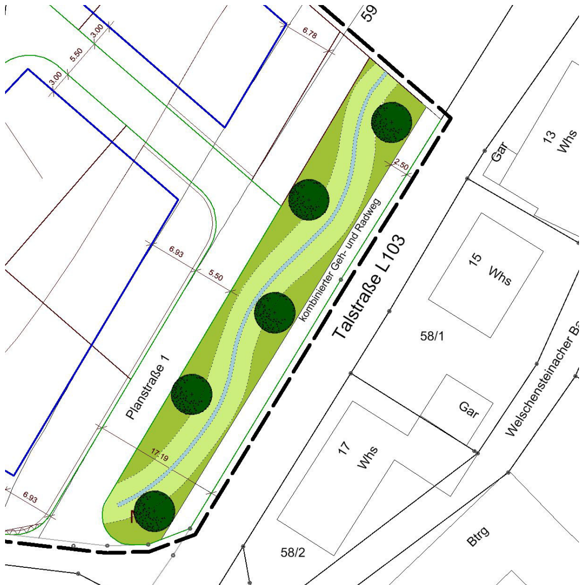
Abb. 1.: Prinzipskizze Grünfläche mit Versickerungsmulde – Lageplan
